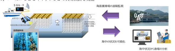
水中ドローンを活用した遠隔での海中状況可視化システムにおいては、ローカル 5G を活用して水中 ドローンを陸上から遠隔操作し、海中の状況を可視化することにより、「養殖する牡蠣の生育に影響を与 える付着生物の状況」をリアルタイムで把握することが可能です。その結果、漁業従事者の労働環境の改 善が実現し、結果として牡蠣の海面養殖における生産性の低下の歯止めに繋げられると期待されます。
